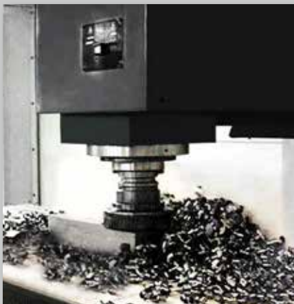
● 9mm Depth Face Milling (50#)
